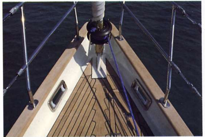
Sopra: schiacciate dal teleobiettivo, le linee di Kinzana mostrano ancor di più la loro imponenza; al timone, il suo armatore. Sotto: avvolgifiocco e cime di prua lavorano liberi da impacci, grazie al sistema d'ancoraggio a scomparsa. Il pozzetto, protetto e confortevole, è concepito in modo da non isolare il timoniere.
